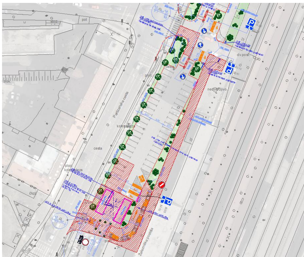
Slika 4.1: V projektu je predvidena zamenjavo ustroja na šrafiranem območju. Predlagamo zamenjavo tudi drugod, kjer se to izkaže kot nujno potrebno.
