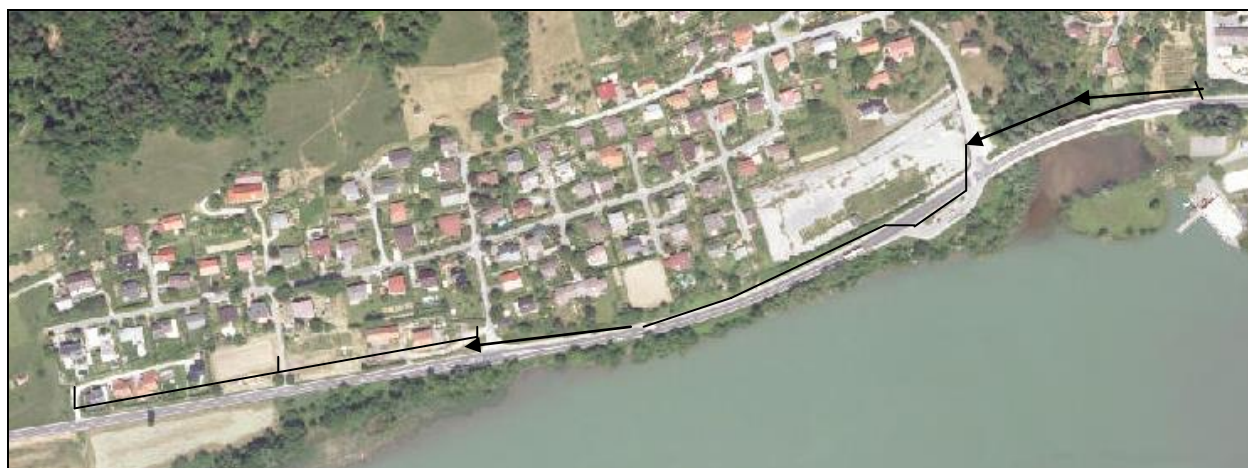
Slika 2: Pregledna situacija trase predvidenega vodovodnega cevovoda
