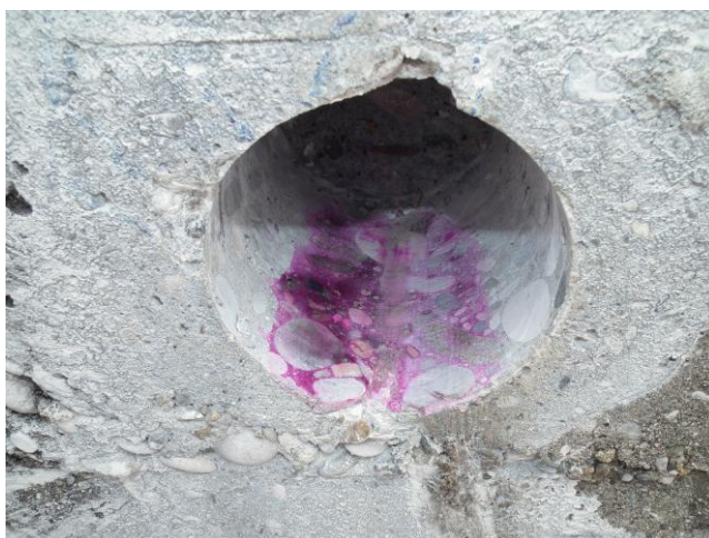
Slika 9: sonda V2, ugotavljanje globine karbonaizacije
