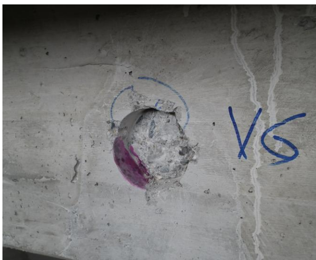
Slika 109: globina karbonatizacije, tribunski nosilec
