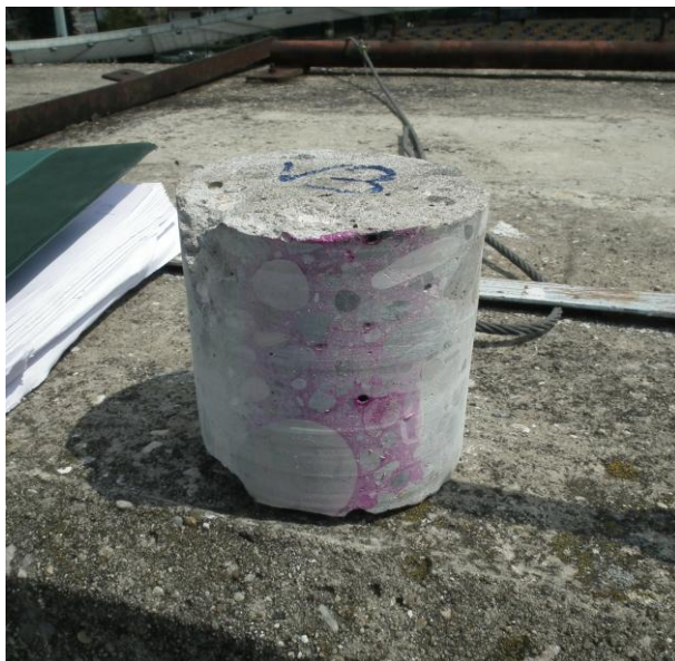
Slika 6: ugotavljanje globine karbonatizacije, vzorec V3
