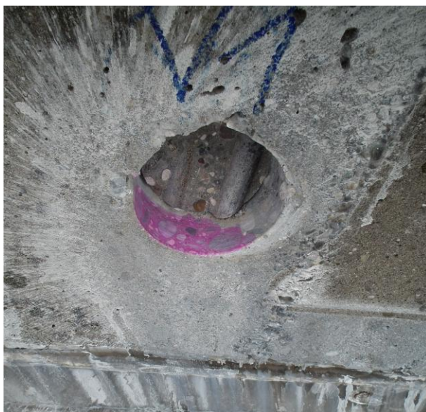
Slika 5: ugotavljanje globine karbonatizacije, vzorec V1
