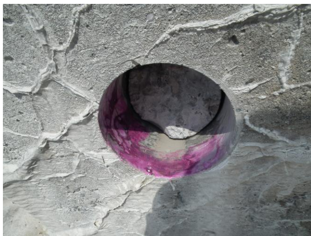
Slika 65: globina karbonatizacije nosilca N10
