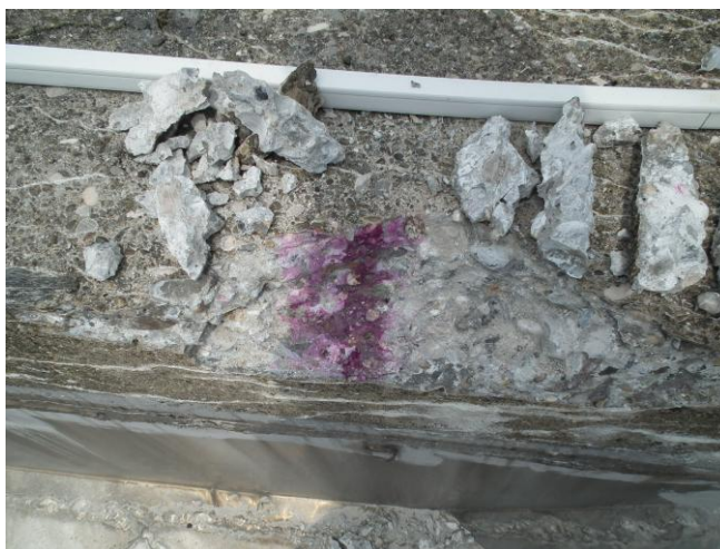
Slika 13: globina karbonatizacije v zahodnem delu N1
