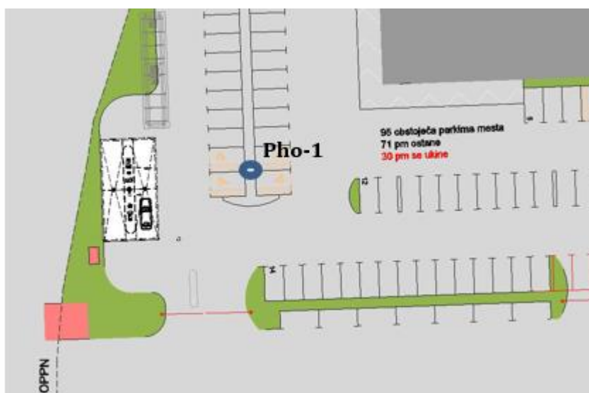
Slika 19. Varovalni ukrep s postavitvijo piezometra PHo-1
