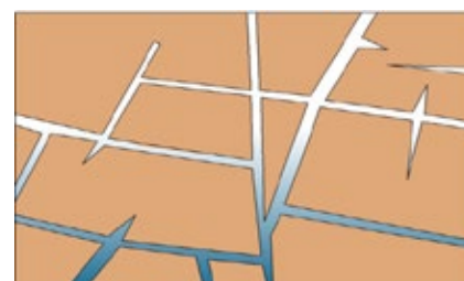
Slika 2: Različni tipi poroznosti: a) medzrnska, b) kanalska oziroma kraška in c) razpoklinska (Spletna stran Colorado Geological Survey)
