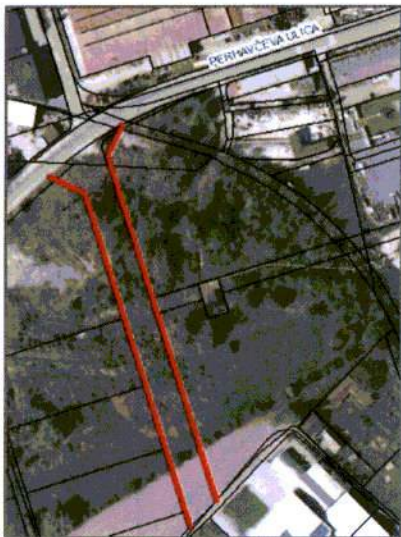
Slika 8: Trasa načrtovane ceste K5–K8 I. etapa, km 0+000 do km 0+240
