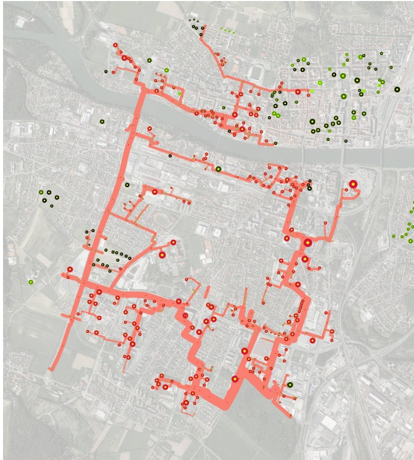
Slika 2-1: Obstoječe vročevodno omrežje leta 2020
