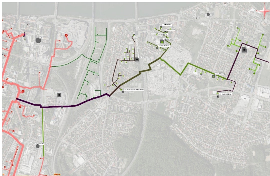
Slika 3-5: Vročevodno omrežje na Pobrežju leta 2030
