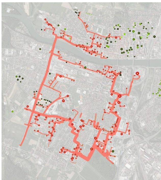
Slika 3-1: Obstoječe vročevodno omrežje leta 2020
