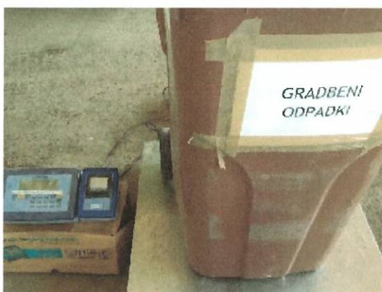
Slika 29: Tehtanje gradbenih odpadkov
