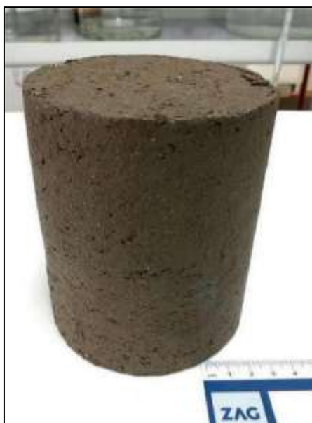
Slika 6.13: Izdelani kompozit iz blata ČN in pepela 19 .
