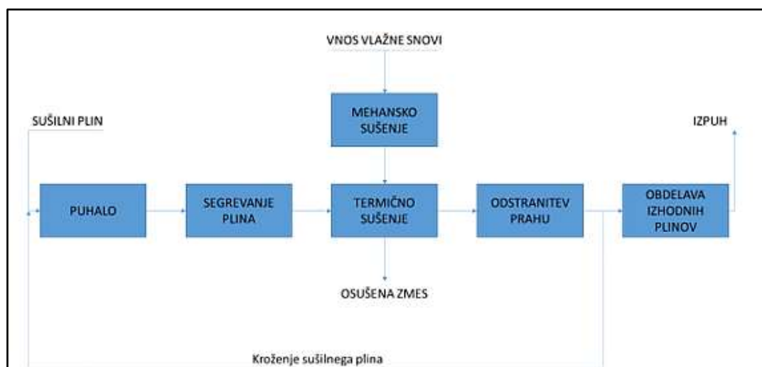
Slika 12.34: Značilni sušilni sestav procesnih enot pri sušenju.
